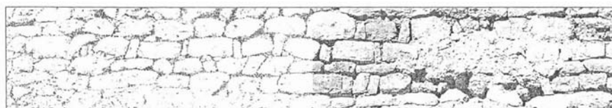
Figg. 17a-c – Assergi, Chiesa di S. Maria Assunta . Pianta della chiesa e della cripta (da Moretti 1971, 148). Facciata posteriore e rilievo di un particolare della muratura (indicato sulla pianta) con elementi disposti alternativamente in orizzontale ed in verticale.
